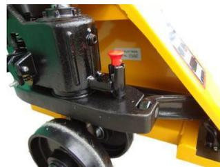
Unidad hidráulica compacta con válvula de sobrecarga y seguro para desplazamiento transversal
